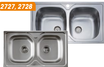
DE-165 2 medence, méret: 860x500 mm, medenceméret: 360x390x190 mm, leeresztő mérete: 3 1/2", 190 mm mély medence, 0,7 mm anyagvastagság AE 860C 2 medence, méret: 860x500x160 mm, leeresztő méret: 3 1/2"
